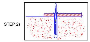
INSERT THE ANCHOR THROUGH THE LOWER HINGE GUARD BASE. DRIVE THE SCREW INTO THE ANCHOR BODY TO EXPAND IT. BE SURE THE HEAD IS SEATED FIRMLY AGAINST THE BASE AND THAT THE ANCHOR IS AT THE PROPER EMBEDMENT.
