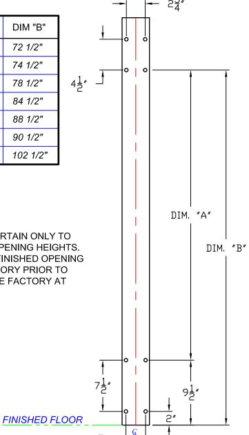
NOTE: DIMENSIONS LISTED PERTAIN ONLY TO STANDARD FINISHED OPENING HEIGHTS. PLEASE VERIFY YOUR FINISHED OPENING HEIGHT WITH THE FACTORY PRIOR TO DRILLING. CONTACT THE FACTORY AT 1-800-547-6856.
